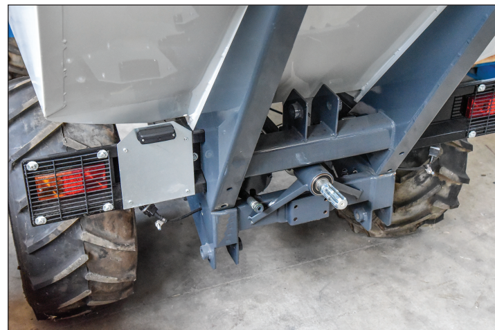
PTO + ATTACCO POSTERIORE A 3 PUNTI PTO + REAR 3-POINT LINKAGE
